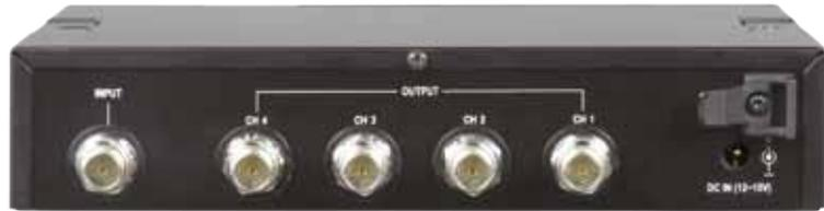
Der aktive UHF Antennensignalsplitter AD-90S deckt einen Frequenzbereich von 470 MHz bis 850 MHz ab und ist für den Betrieb von bis zu vier UHF Sendeantennen an einem Signalausgang vorgesehen. Dies erleichtert nicht nur die Installation, sondern erhöht auch die Empfangssicherheit. Die Gesamtverstärkung vom Antenneneingang zu jedem Ausgang beträgt etwa Faktor 1, somit treten keine Pegelverluste wie in passiven Splittern auf.
