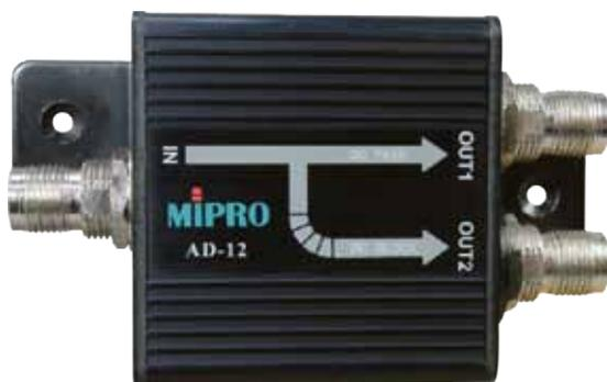
Mit dem passiven 2-Kanal Antennencombiner / -Splitter AD 12 (2 in 1) können bis zu zwei Sendeeinheiten über eine einzelne Sendeantenne betrieben werden (Einsatz bei In-Ear Systemen). Dadurch werden Intermodulationsverzerrungen, „Rauschen“ und Signalaussetzer reduziert. Der AD-12 kann auch invers als Antennensplitter genutzt werden um mit einer Empfangsantenne zwei Empfängereingänge zu speisen.
