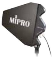
Bei Abständen zwischen Sende- und Empfangsantenne von über 50 Metern können auch zwei MIPRO AT-90W Richtantennen über Antennenkabel am AD-707A Antennensignalverteiler angeschlossen werden. Die AT-90W Antennen empfangen Signale nur von der Vorderseite mit größerem Gewinn. Wenn die Kabellänge zwischen AD-707A und Antennen mehr als 10 Meter beträgt, kann die Antenne AT-90W aktiv betrieben werden.
