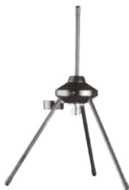
Die AT-70 ist eine Breitband, Rundstrahlantenne (Groundplane) mit kugelförmiger Empfangscharakteristik. Die Impedanz beträgt 50 Ohm. Die AT-70 wird mit TNC-Verbindungskabeln mit der TNC-Eingangsbuchse der drahtlosen Empfänger verbunden. Die Antenne kann auf einem Dreifußstativ (MS-30) befestigt werden und ist für Anwendungen mit größerer Reichweite geeignet.
