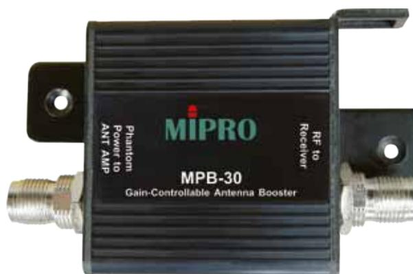
Der automatische Antennensignalverstärker MPB-30 kann in Verbindung mit dem AD-708 Antennensignalverteiler seine Verstärkung automatisch, entsprechend der im System durch Signalleitungen entstehenden Dämpfung, anpassen um dem Empfänger immer das optimale Eingangssignal zu liefern. Der MPB-30 kann durch eine externe Spannungsversorgung (12-24 V DC) oder direkt durch die 8 V, die durch die Signalleitung von ACT-Empfängern oder Antennenverteilern geliefert werden, versorgt werden.
