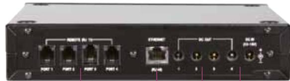
RJ-11 Ports      Ethernet Port      DC Eingang
