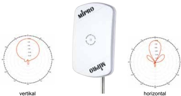
Spezielle aktive Empfangsrichtantenne (2,4 GHz), ist verwendbar für drahtlose Mikrofonsysteme der ACT-2400 Serie. Der eingebaute Verstärker (12 ±1 dB) dient zum Ausgleich von Dämpfungsverlusten bei Koaxialkabeln. Die AT-24 kann auf einem Mikrofonstativ befestigt oder mit der integrierten Schwenkadapterhalterung an der Wand befestigt werden. Die AT-24 ist wetterfest und somit auch für den Außeneinsatz geeignet. Für besten Diversity-Empfang wird die Verwendung von zwei AT-24 empfohlen.
