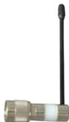
Die AT-10 ist eine Breitband,  $\lambda/4$  Stabantenne mit kugelförmiger Empfangscharakteristik. Die Impedanz beträgt 50 Ohm. Die AT-10 kann direkt auf die TNC-Eingangsbuchse der drahtlosen Empfänger geschraubt werden. Die Antenne ist für Nahanwendungen geeignet.
